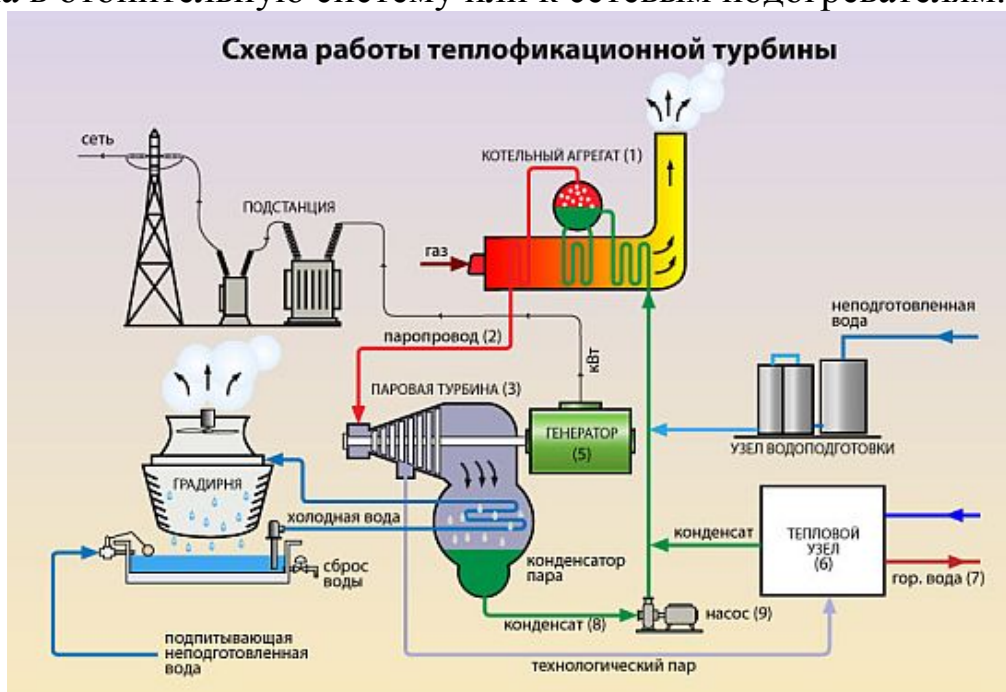
Рисунок 40 – Схема работы теплофикационной турбины
